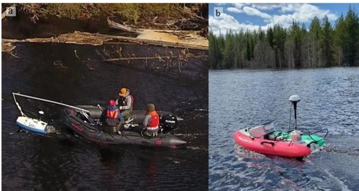
Kuva 15. Kevään mittausjaksolla akustisen virtausprofiilimittarin alustana käytettiin moottoriveneen keulaan kiinnitettyä lauttaa (a) ja syksyn mittausjaksolla kauko-ohjattava lauttaa (b). Kuvat: Linnea Blåfield (a) ja Karoliina Korkiakoski (b)
