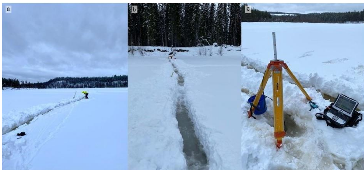
Kuva 14. Talven mittausjakson mittausolosuhteet (a) ja poikkileikkaus 1 (b). ADCP-mittauksessa sensori kiinnitettiin metallitankoon, joka kiinnitettiin kolmijalkaan (c). Kuvat: Karoliina Korhikoski
