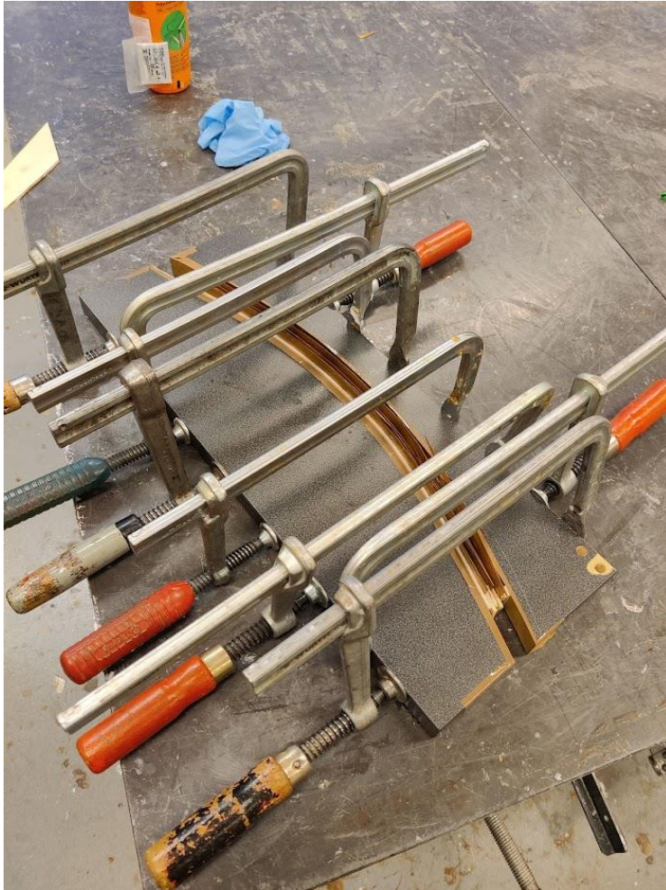
Kuva 17. Ohjaustanko liimauksessa ja puristuksessa muotin välissä.
