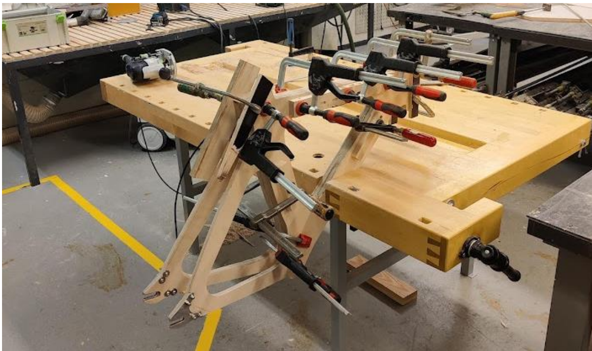
Kuva 12. Rungon puolikkaiden liimaus.
