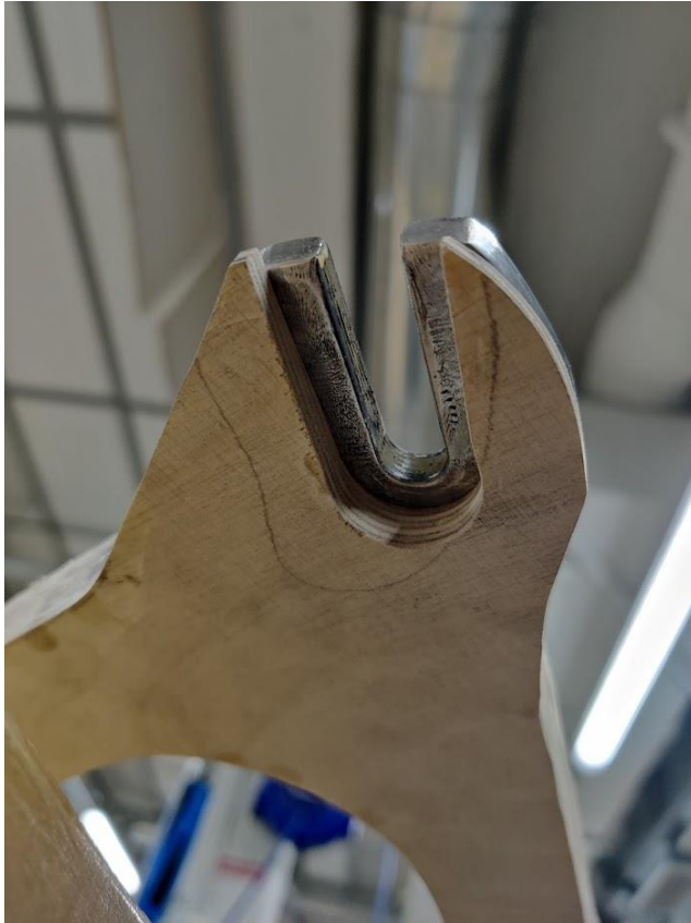
Kuva 11. Takahaarukkaan sisäpuolelle akselia varten tehty ura.
