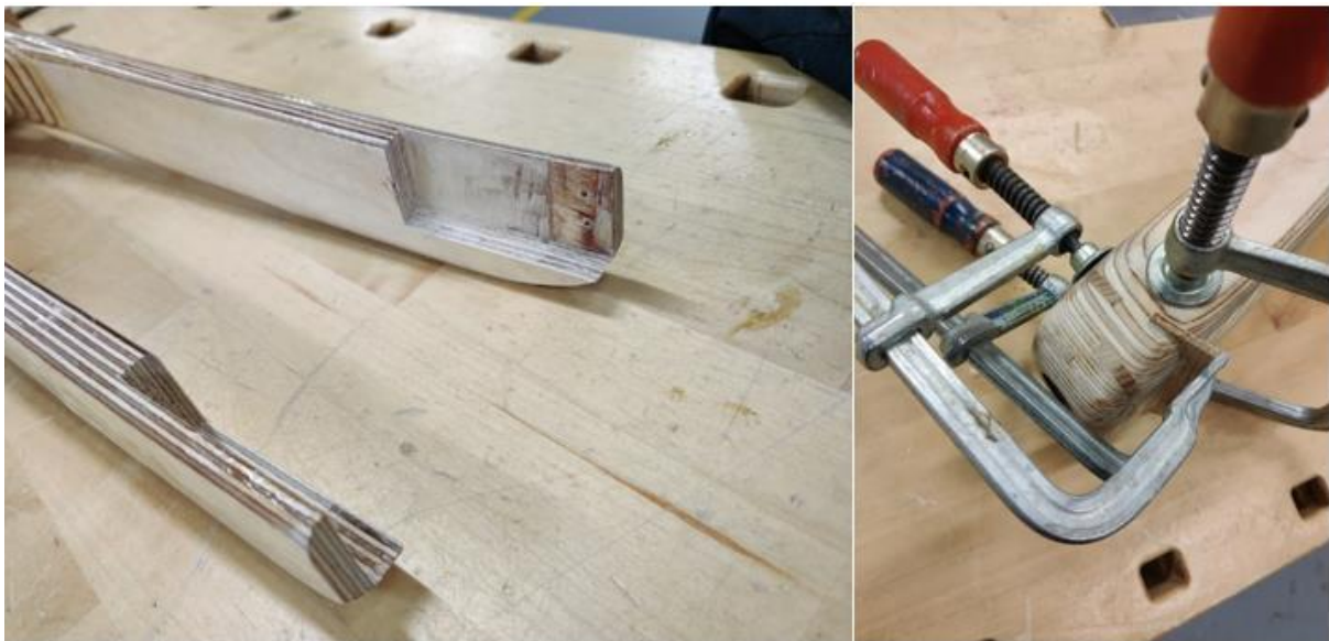
Kuva 19. Etuhaarukka ilman alumiinivahvikkeita ja tammi listojen liimaaminen vahvikkeiksi.
