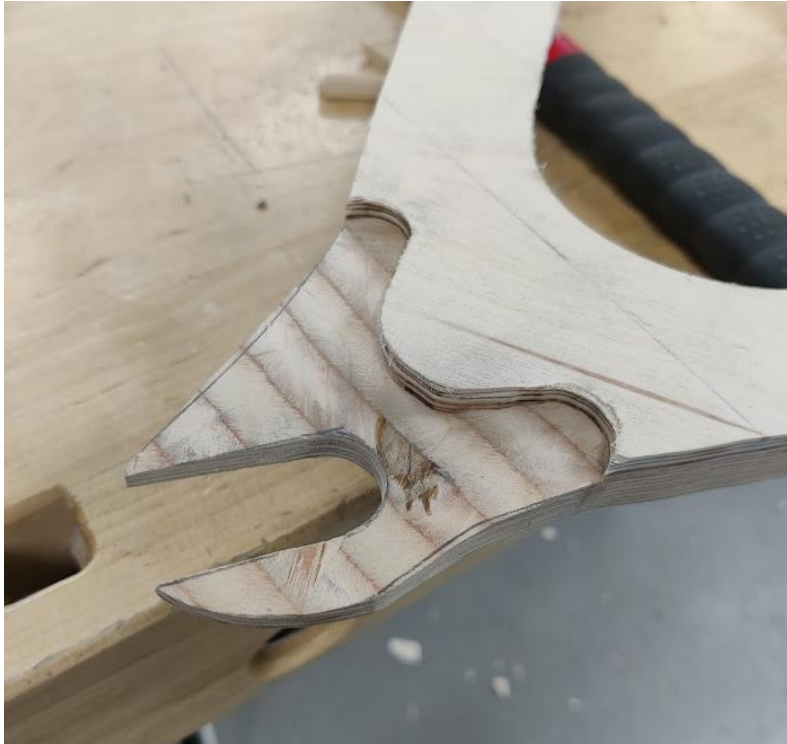
Kuva 9. Alumiiniselle haarukanpäälle jysinkelkkaa apuna käyttäen jysitty paikka.
