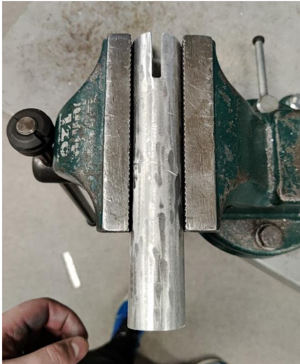
Kuva 13. Satulatulppaa varten satulaputkeen istutettava putki.
