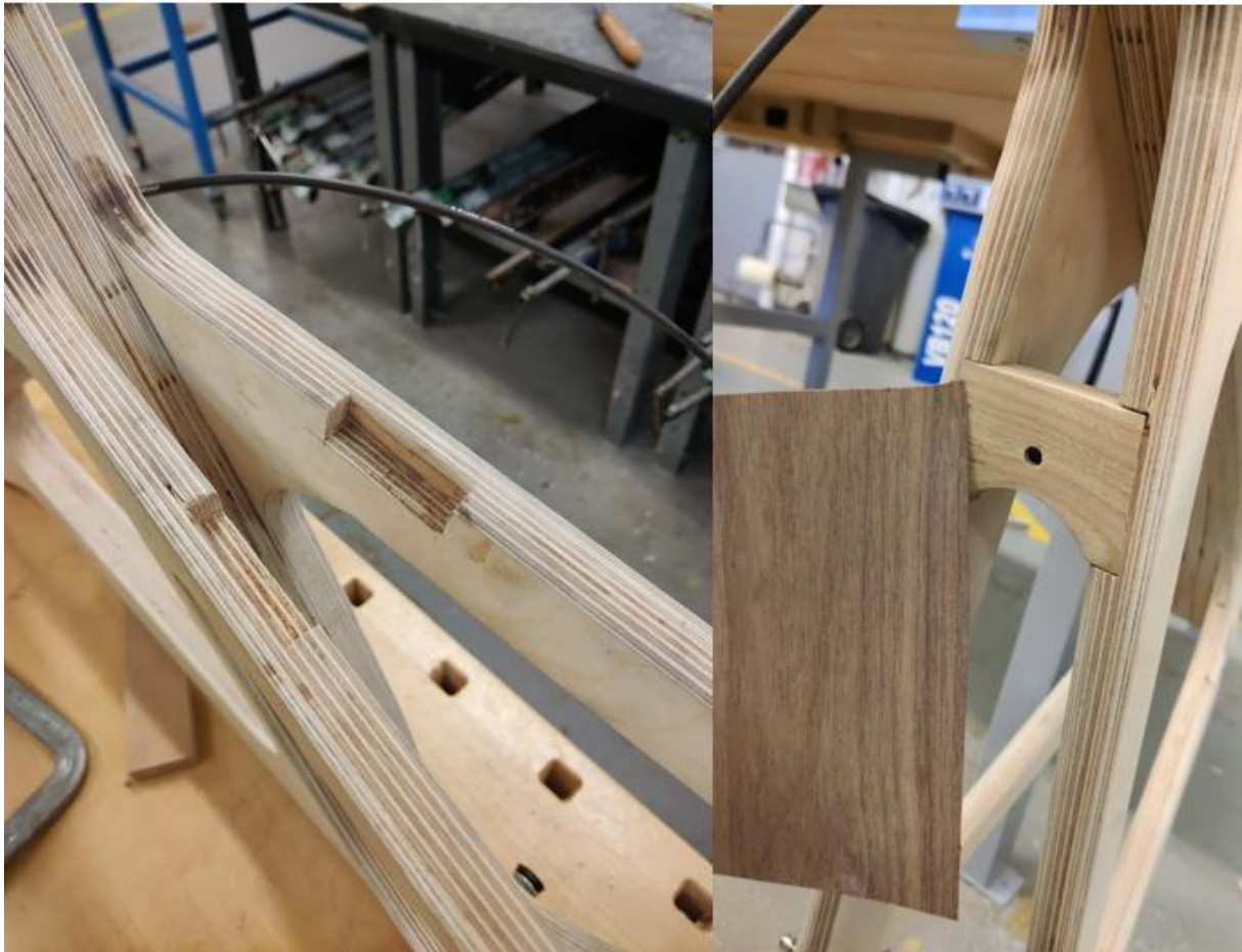
Kuva 18. Kolo vahvikkeelle ja vahvike paikoillaan.
