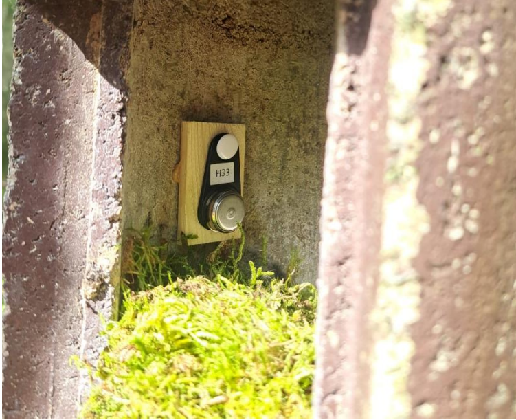
Kuva 2. Kosteus- ja lämpötilamittari isobritannialaisessa puubetonipöntössä asennuksen jälkeen.
