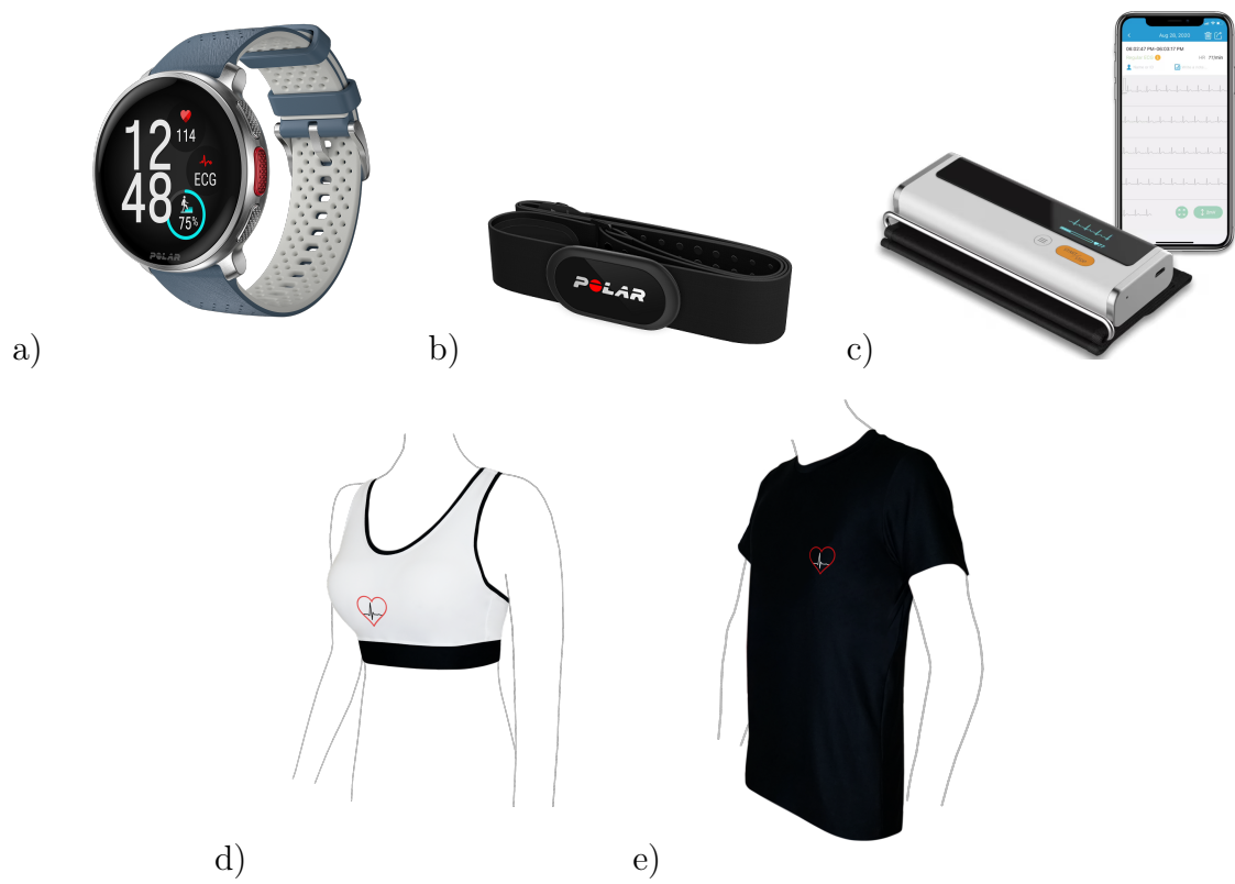
Kuva 3.1: Mallikuvat alalukujen 3.1–3.4 puettavista laitteista. a) älykello, b) sykevyö, c) käsivarsinauha (kehitteillä on myös huomattavasti pienempiä malleja), d) urheiluliivi, e) t-paita. [20], [21], [22].
