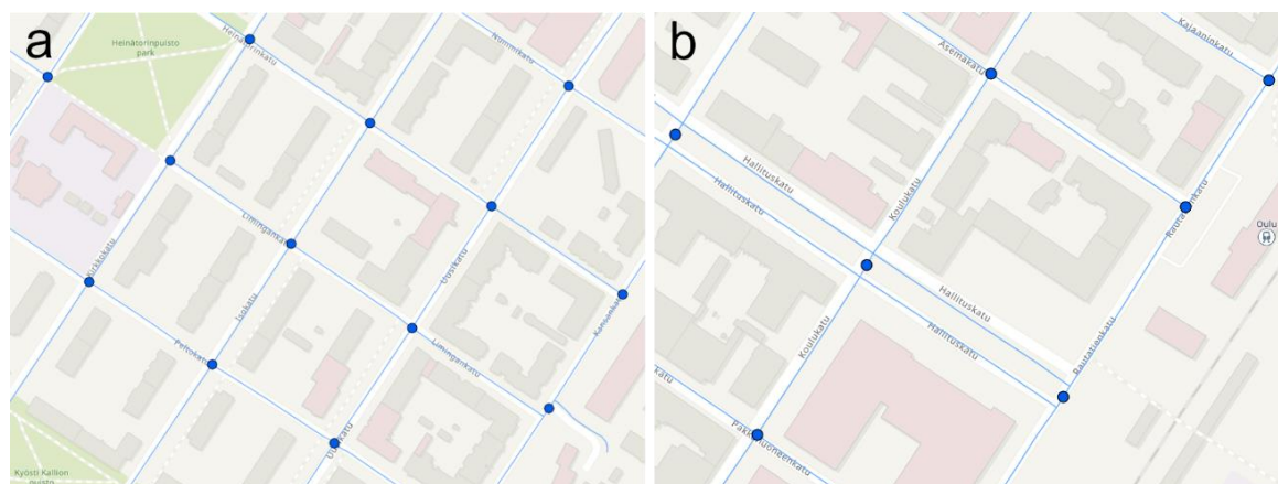
Kuva 14. Tielinkit ja työkaluketjulla muodostetut liittymäpisteet Oulun keskustassa. a) Liittymäpisteet, joiden tiet koostuivat yhdestä linkistä. b) Liittymäpisteet, joissa oli useampia tielinkkejä samalla tiellä.
