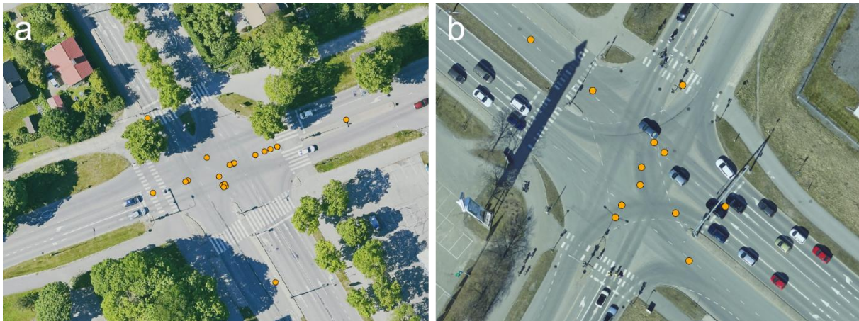
Kuva 17. Turun onnettomuusalttiimmat liittymät. a) Kaskenkadun ja Kunnallissairaalan tien liittymässä onnettomuudet olivat keskittyneet liittymän keskiosaan. b) Jaanintien ja Kalevantien liittymässä onnettomuuspaikkoja oli tasaisesti laajan liittymän eri kaistoilla.
