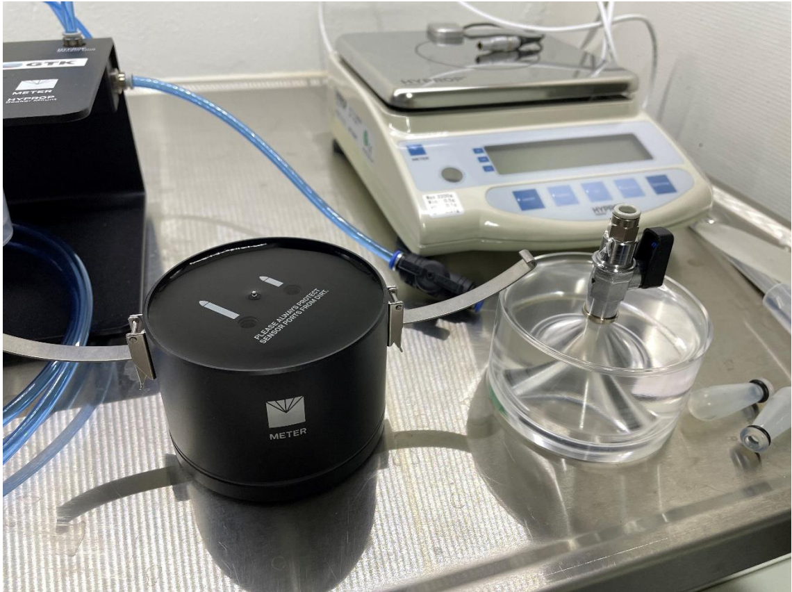
Kuva 11. Täyttöadapteri ilmauksen jälkeen poistettuna sensoriyksikön päältä. Veden tulee pysyä sensoriyksikön päällä, jotta sensorit eivät altistu ilmalle. Taustalla oleva muovinen venttiili särkyi osittain tutkimuksen aikana. Kuva: Teemu Mölsä
