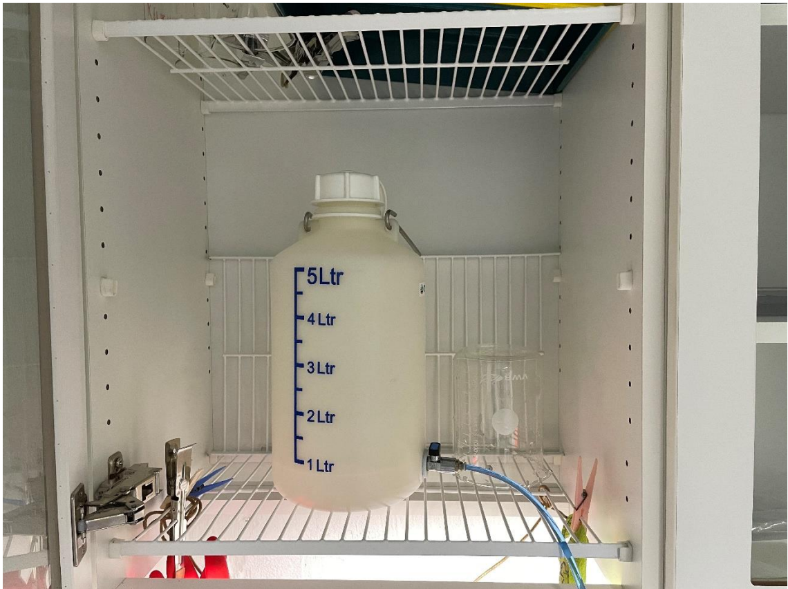
Kuva 18. Viiden litran kanisteri sijoitettiin laitteen yläpuolelle, josta vesi pääsi virtaamaan mittausyksikköön. Kuva: Teemu Mölsä
