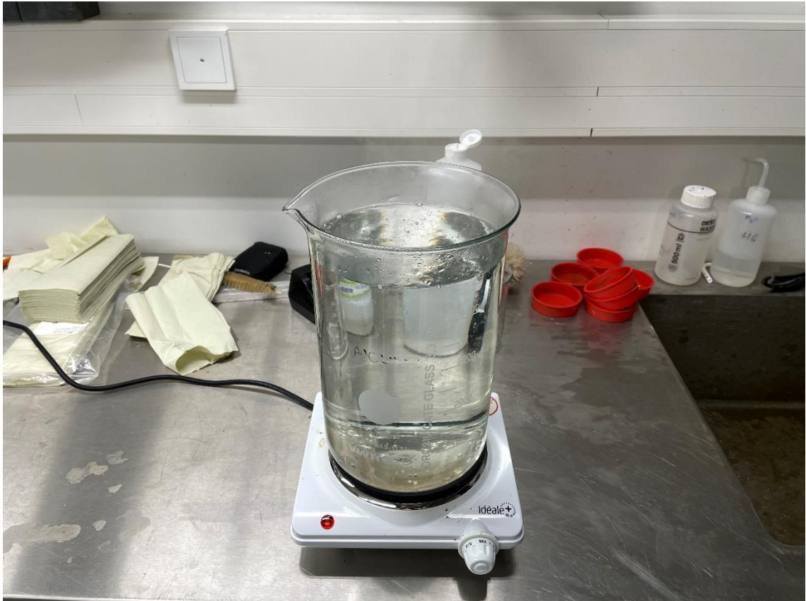
Kuva 4. Tislattua vettä keitettiin 10 minuutin ajan 5000 millilitran dekanterilasissa liuenneen hapen poistamiseksi ja sen annettiin jäähtyä huoneenlämpöiseksi. Kuva: Teemu Mölsä.
