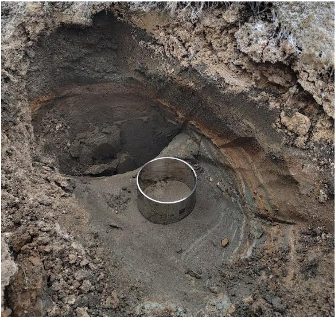
Kuva 2. Rikastushiekka-altaan reunalta kerätty häiriintymätön näyte rikastushiekasta. Kuva: Teemu Karlsson GTK
