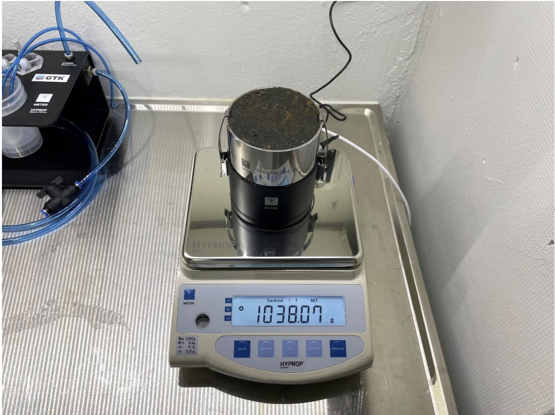
Kuva 15. Vaa'an pintaan on piirretty kaavio, missä asennossa sensoriyksikkö tulisi asettaa vaa'alle. Vaa'assa kiinni oleva musta kaapeli kiinnitettiin sensoriyksikköön ja valkoinen USB-kaapeli vaa'asta tietokoneeseen. Kuva: Teemu Mölsä
