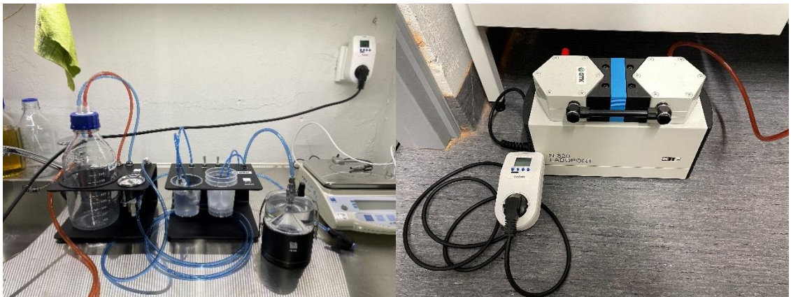
Kuva 3. HYPROP-2 mittausjärjestelmän instrumentit. Kuvassa vasemmalta oikealle, vakuumpullo ja manometri, dekanteriyksikkö, joissa suoritetaan tensiometrien ilmaus, varsinainen sensoryyksikkö ja siinä kiinni oleva täyttöadapteri ilmausta varten, vaaka sekä suuritehoinen vakuumpumppu. Tutkimukseen hankittiin myös ajastimella toimiva kytkin, joka kontrolloi vakuumpumpun toimintaa. Kuva: Teemu Mölsä
