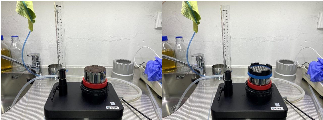
Kuva 20. Näytesylinteri asetettiin mittauskupolin päälle ja siihen kiinnitettiin ylempi suodin sinisen tiivisteiden kanssa. Kuvassa mittauksissa käytetty metallinen verkko. Taustalla hopeanvärinen alumiininen kiinnityskansi. Kuva: Teemu Mölsä
