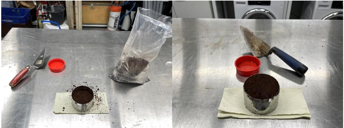
Kuva 5. Häiriintyneet näytteet valmistettiin identtisin tavoin, täyttämällä näytesylinterit vaiheittain viidessä kerroksessa tiivistäen ja pinnat tasoitettiin varovasti muurauslastan avulla. Kuva: Teemu Mölsä
