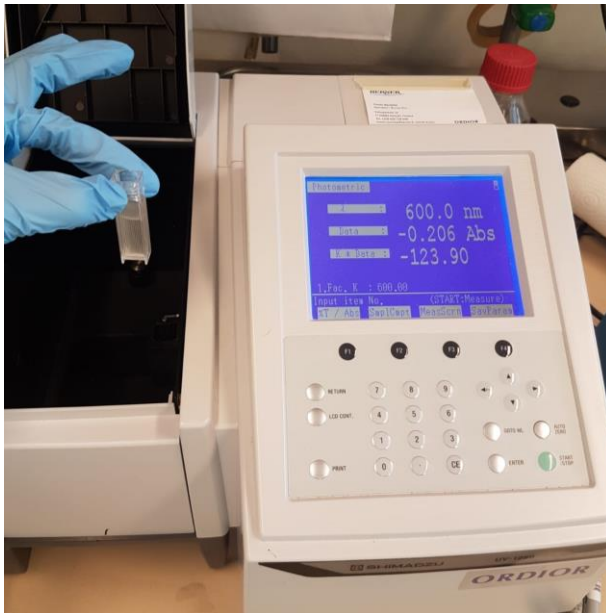
Kuva 7. Mittasin bakteerisuspensioiden absorbanssin spektrofotometrillä. Spektrofotometri kertoo näytteen absorbanssin valitulla aallonpituudella: mitä suurempi absorbanssi, sitä tiheämpi bakteerikasvusto.
