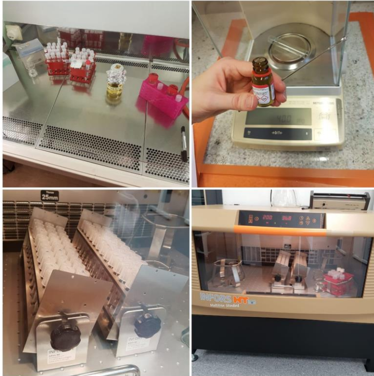
Kuva 6. Bakteeriviljelyvälineitä. Ylhäällä: bakteerisuspensioputkia ja LB-elatusainetta laminaarikaapissa sekä puhtaan glyfosaatin punnitusta. Alhaalla: bakteerisuspensiot ravistelevassa inkubaattorissa.
