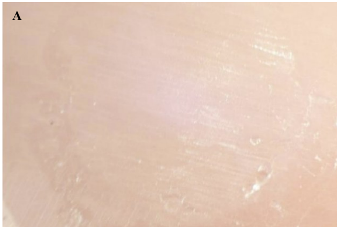
Kuva 5. A. Mikroskooppikuva adhesiivisesta murtumasta, jossa nähdään tasainen pinta. B. Mikroskooppikuva kohesiivisesta murtumasta, jossa pinta on kuopalla. 3D-tulostettu kiskoryhmä oli ainoa, jossa esiintyi kohesiivisiä murtumia.
