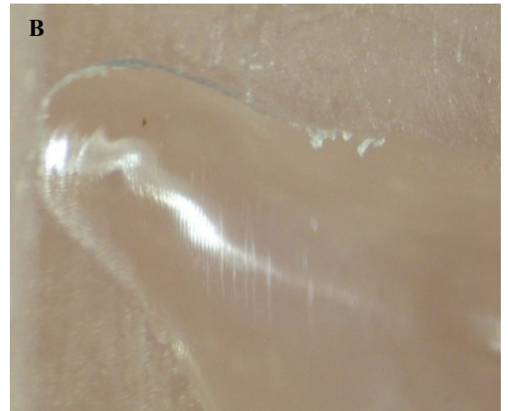
Kuva 5. A. Mikroskooppikuva adhesiivisesta murtumasta, jossa nähdään tasainen pinta. B. Mikroskooppikuva kohesiivisesta murtumasta, jossa pinta on kuopalla. 3D-tulostettu kiskoryhmä oli ainoa, jossa esiintyi kohesiivisiä murtumia.
