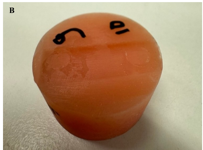
Kuva 6. Perinteisellä (A) ja jyrksityllä (B) kiskomateriaalilla kaikki murtumat olivat adhesiivisia riippumatta sidostustavasta.
