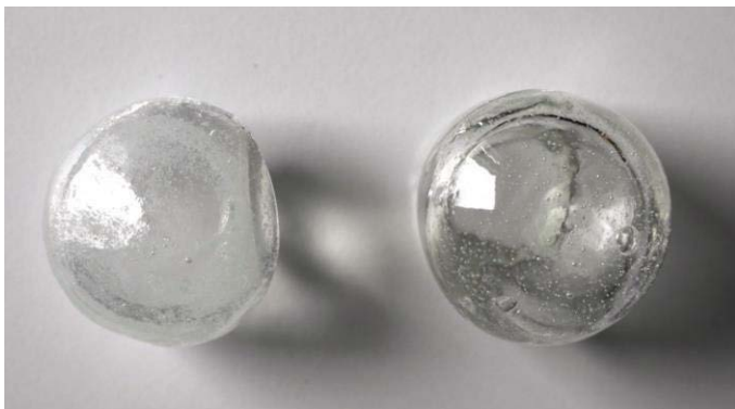
Kuva 74: Bioaktiivisesta lasista perinteisellä tavalla muottiin puhallettuja lasipalloja. Materiaalin 45S5 lasimassa on kiteytynyt ja oikeanpuoleinen turkulaisesta materiaalista 13–93 tehty on pysynyt läpinäkyvänä, molemmissa on ilmakuplia. Kuva: Laura Aalto-Setälä.
