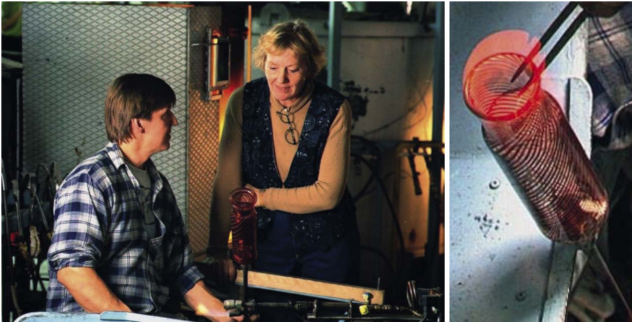
Kuvat 60–61: Kerttu Nurmisen suunnittelema filigraanilasisarja Palazzo on moniosainen ja sarjatuotantona valmistettu tuote. Tekniikkaa käytettiin yleisemmin yksittäistuotteisiin tai piensarjoihin. Suunnittelija todistaa lasinpuhaltaja Reima Maarosen ammattiosaamista Palazzo-maljakon teossa. Kuvat: INDAVin kuva-arkisto.
