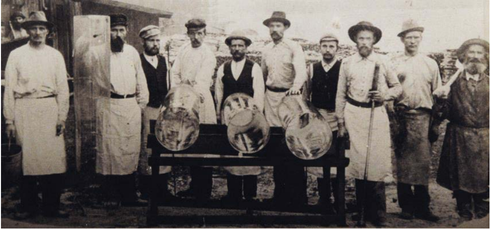
Kuva 79: Enonkoskelta Kangassaaren lasitehtaan ammattiväkeä ja käsityöajan ikkunala-silieröitä noin vuodelta 1895. Kuvassa Janne Torstenssonin isoisän isä Karl Axel Torstensson viides oikealta ja hänen veljensä Karl Johan kolmas oikealta. Kuva: Janne Torstenssonin albumista.
