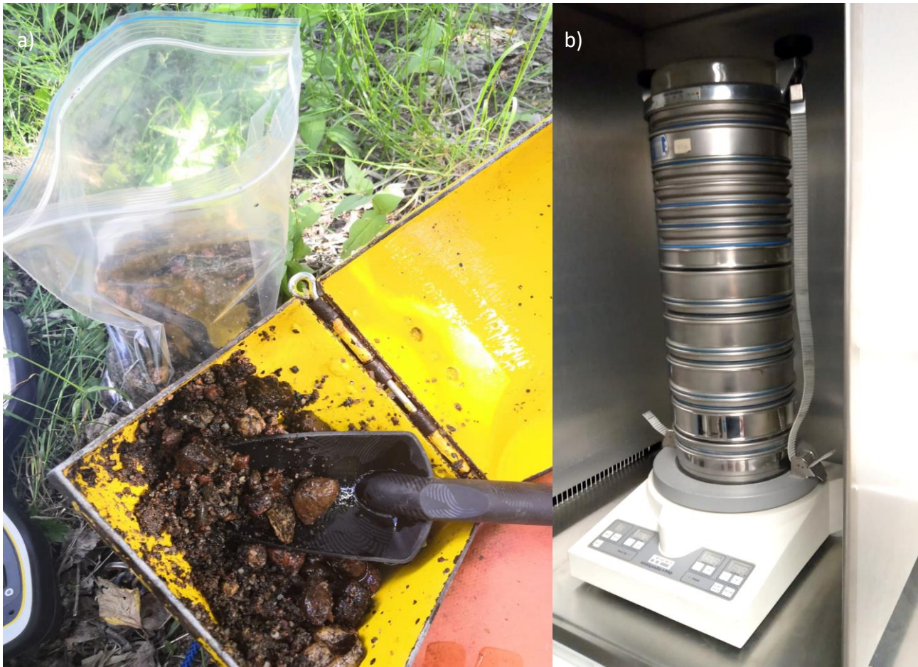
Kuva 21. Sedimenttinäytteet kerättiin uoman pohjasta Van Veen -keräimellä (a), minkä jälkeen näytteet kuivaseulottiin laboratoriossa (b).
