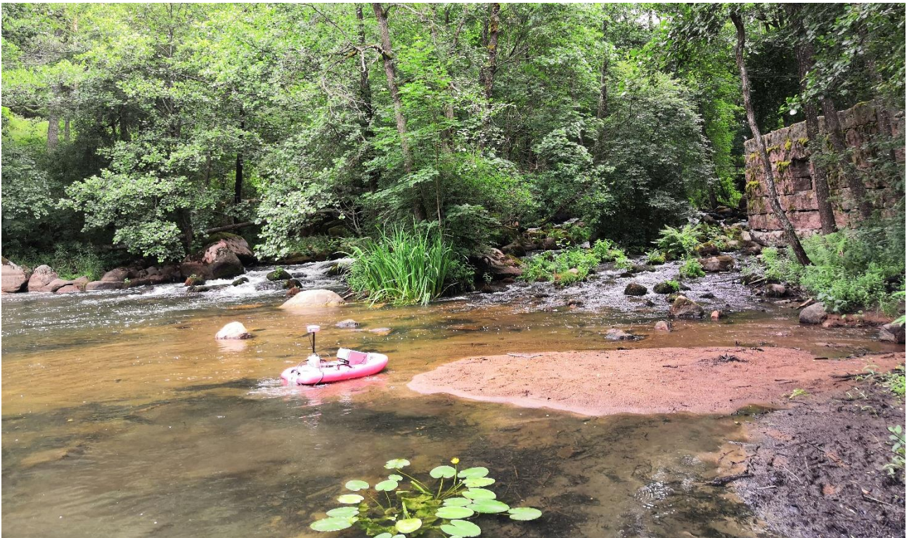
Kuva 15. ADCP-syvyysmittausta Alisen kosken alapuolisella suvantoalueella. Kesällä 2020 suvannon vasemmalla reunalla oli runsaasti kasautunutta hiekkaa (Kuva: Karoliina Lintunen).
