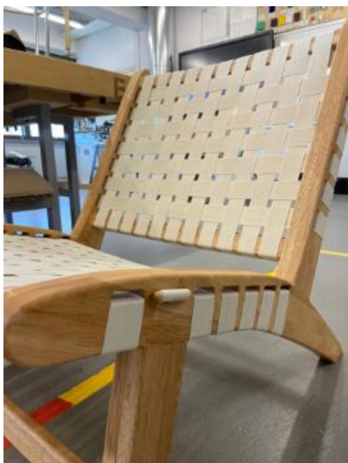
Kuva 2. Jalan kohdalla olevat tapit tuolivyyötä varten
