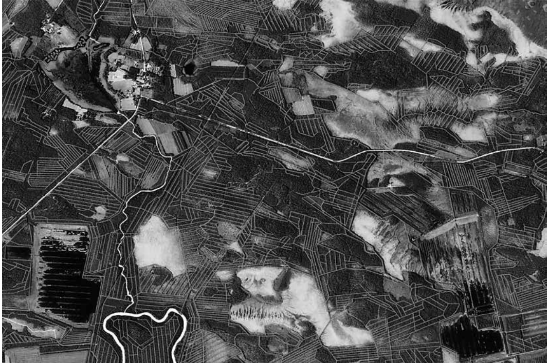
Ilmakuva Hetekylästä vuodelta 2024. Kuvassa näkyy korostettuna ojaverkosto, joka kattaa hyvin merkittävän osan alueen pinta-alasta. Jo ennallistumaan jätetyt turvetuotantoalueet näkyvät kuvassa selvästi. Aineistolähde: Maanmittauslaitoksen ortokuvat, ja NLS-FI INSPIRE Hydrography Theme Dataset. CC-BY 4.0.
