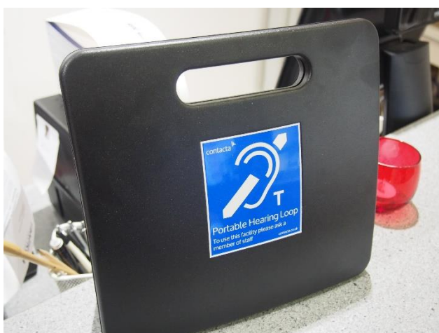
Kuva 4. Kannettava palvelupistesilmukka, joka siirtää puheen kuulokojeeseen. Valokuva: Eveliina Virta
