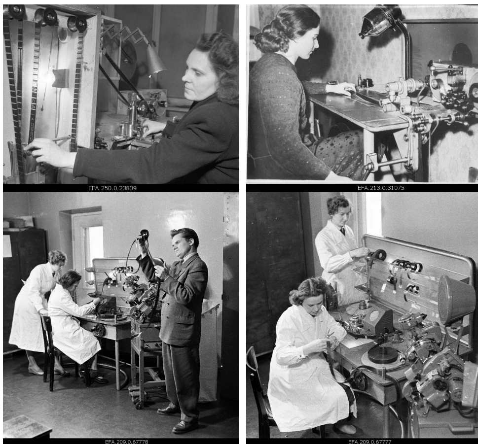
Figure 28. L'operatrice T. Žujeva en train d'imprimer des sous-titres estoniens sur la pellicule (en haut à gauche, 1954, la photo de G. Loss). Le maître des sous-titres Sofia Eero en préparant de la pellicule sur la nouvelle machine de sous-titrage à Tallinna Kinostuudio (en haut à droite, 1956, la photo d'Ü. Laud). Le sous-titrage dans la fabrique de montage à Tallinna Kinostuudio. (en bas, 1959, la photo de Karl Oras).
