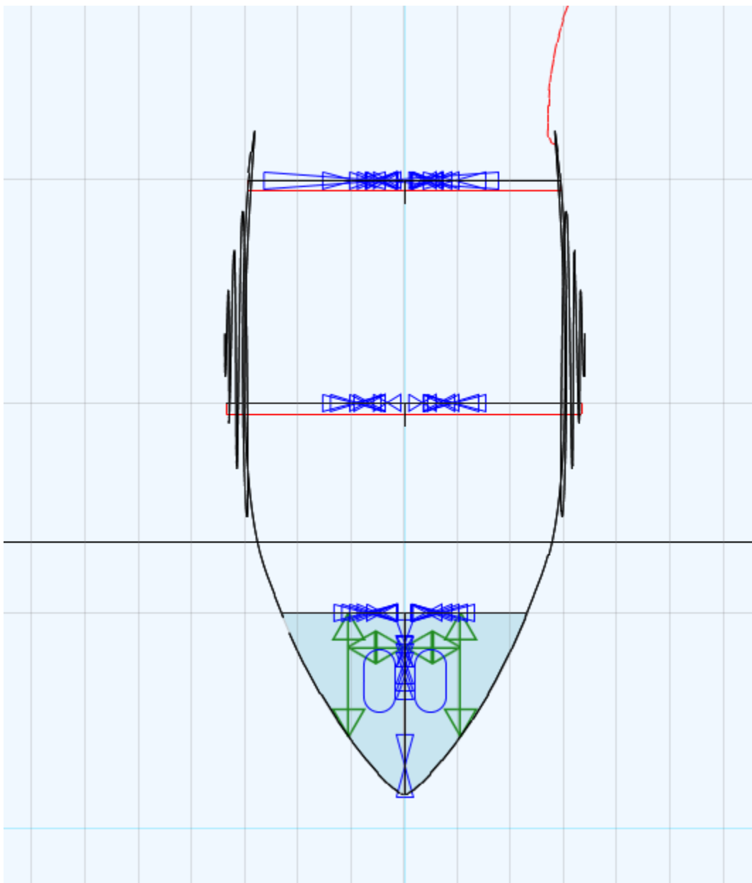
Kuva 12. Poikkileikkaus Nauticus Hull - Ongelma geometrian lukemisessa
