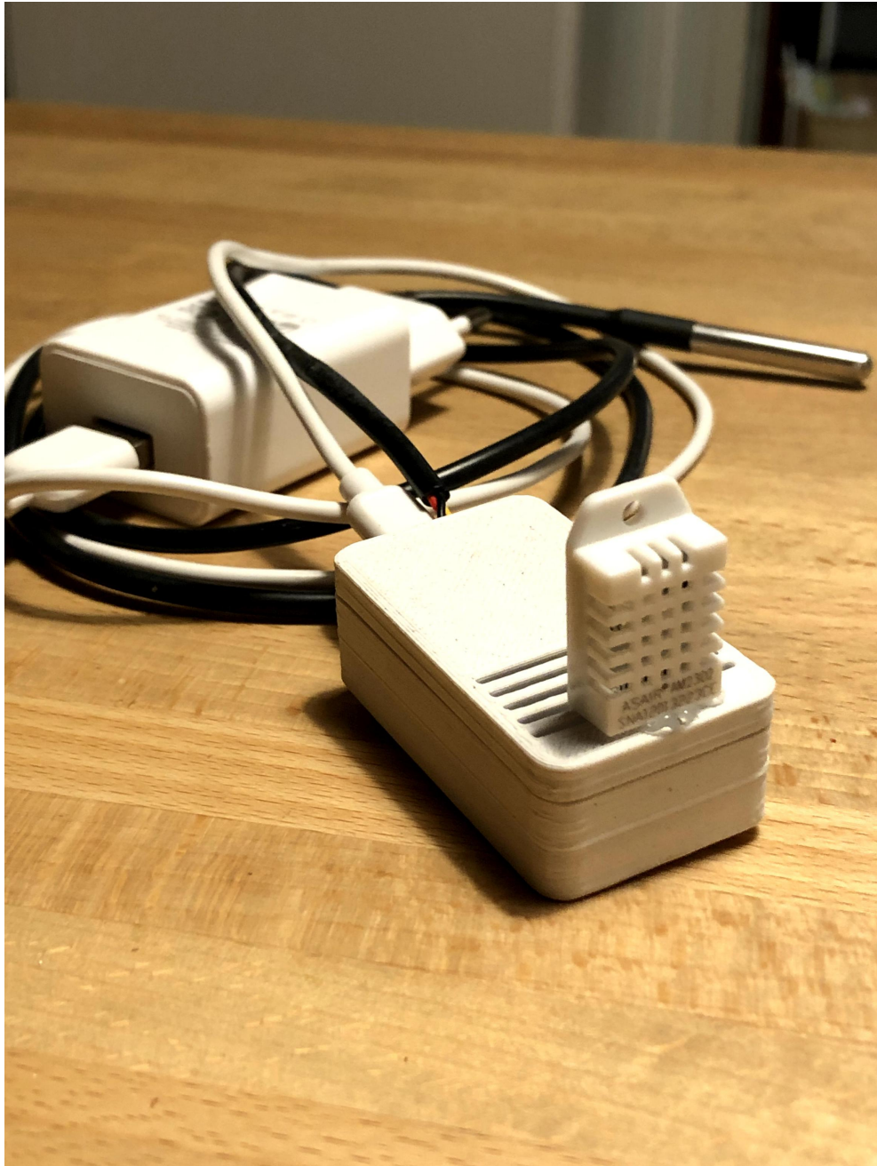
Kuva 4.8: Ulko- ja sisälämpötilaa mittaava anturi valmiina
