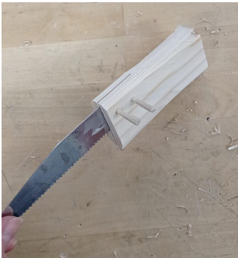
Kuva 8 Saha, jossa veistetty kahva, työkalujen itse valmistamisen perinteen mukaisesti. (T1)
