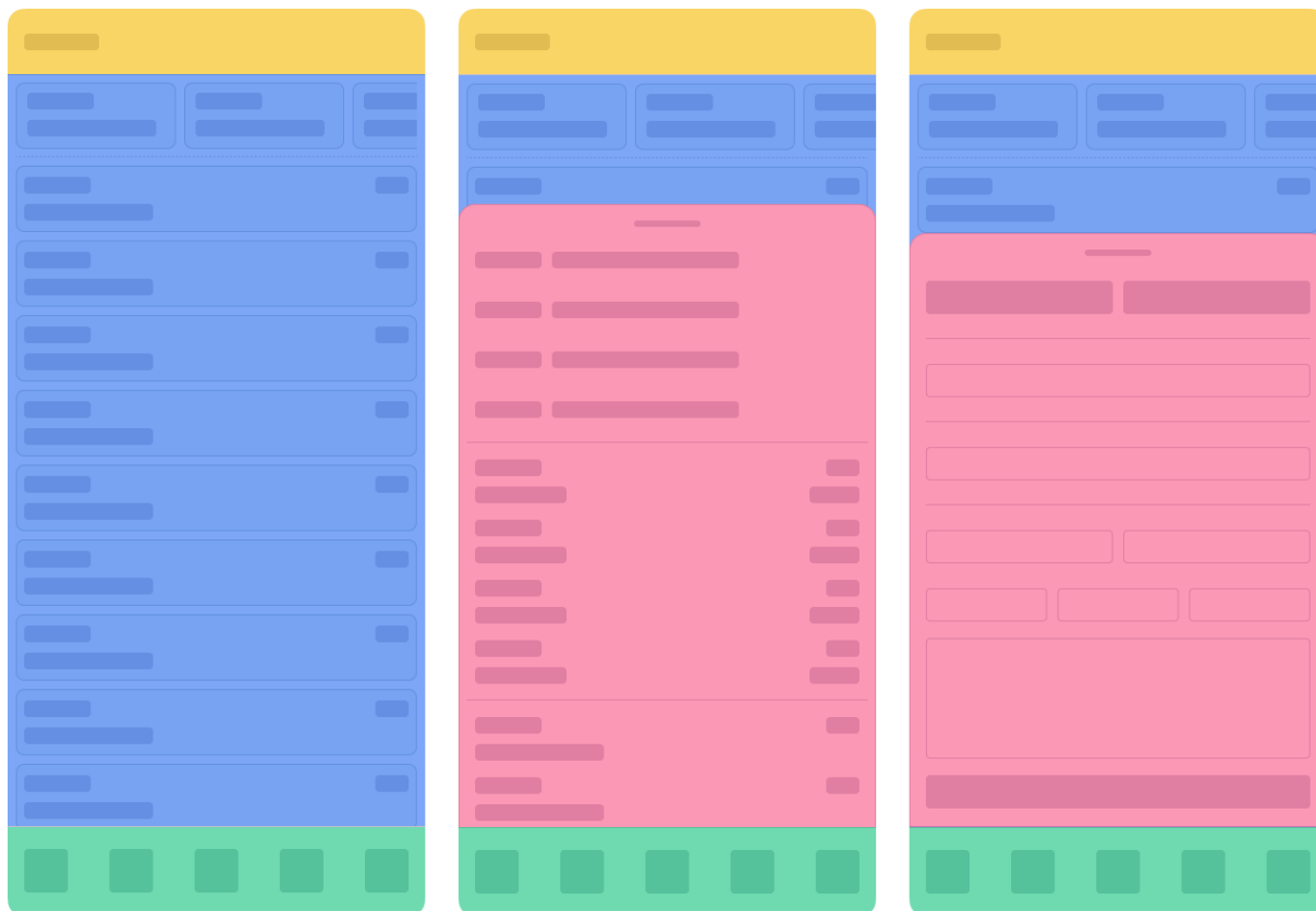
Kuva 4.3. Mobiilikäyttöliittymän värikoodattu rautalankamalli. Keltainen alue edustaa sovelluspalkkia, sininen alue sisältöaluetta, vihreä alue navigointialuetta ja punainen alue sovelluksen toissijaisia ikkunoita, kuten dialogeja
