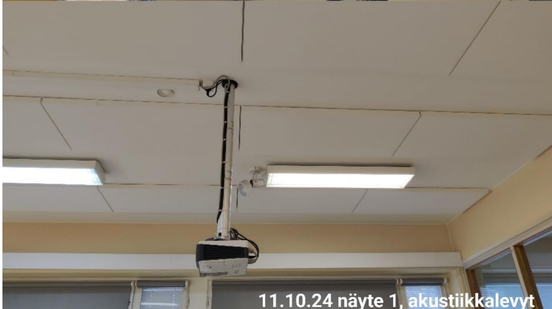
Kuva 6. Näytteen kerääminen tilasta oleskeluvyöhykettä mukaillen keräimen ollessa pulpetilla. Katon akustiikkalevyt olivat mahdollinen teollisten mineraalikuitujen lähde. Kuva: Emilia Turves, 2024.
