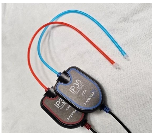
Kuva 19. RadioEar IP30 -inserttikuulokkeet eli korvakäytäväkuulokkeet. Punaisella tehostevärillä merkitty kuuloke asetetaan oikeaan korvaan ja sinisellä värillä merkitty vasempaan.
