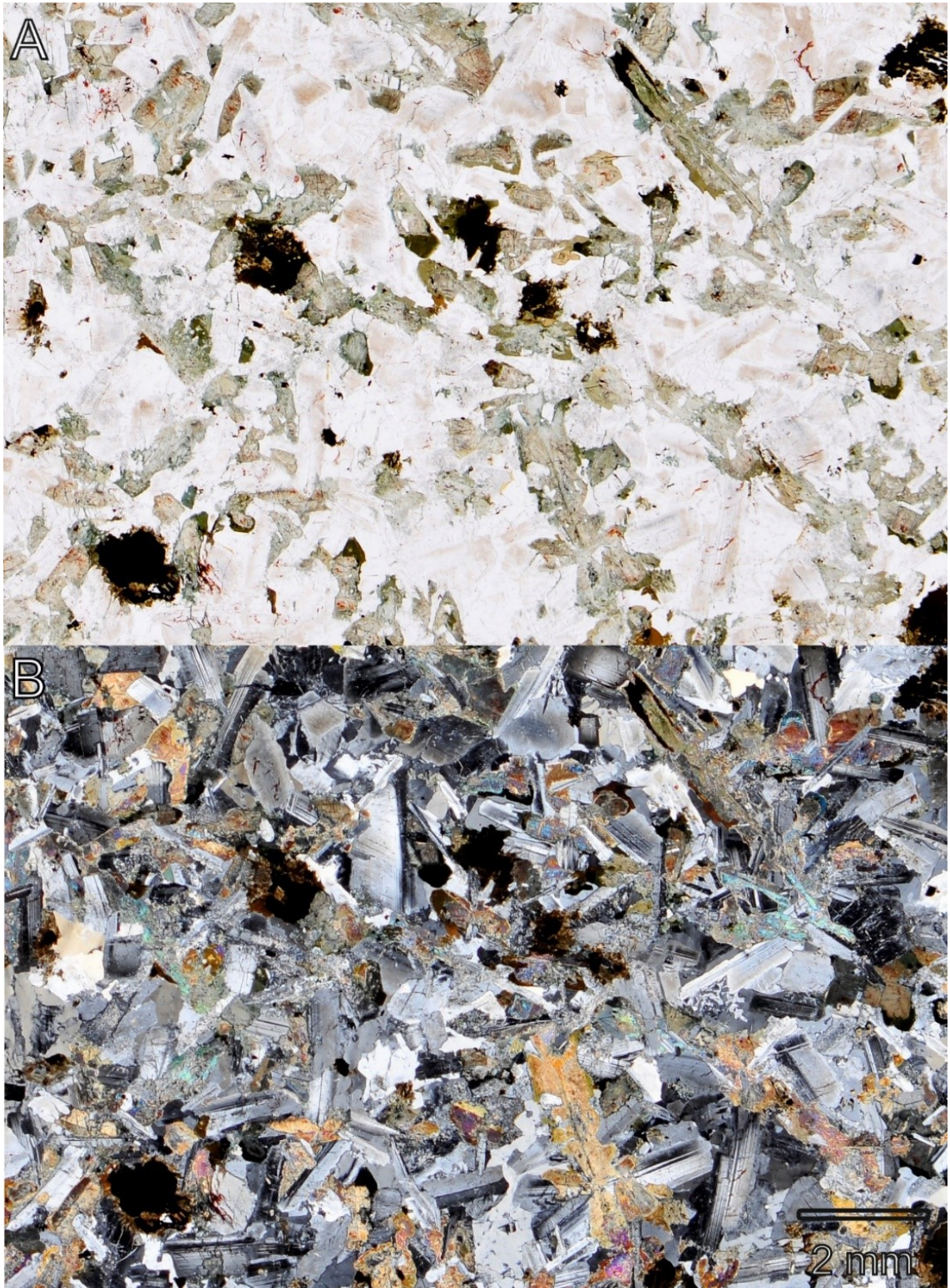
Kuva 15. Polarisaaatiomikroskooppikuva syvyydeltä 557,85 m diabaasista (hie nro. 201189), jossa esiintyy diabaasille tyypillinen ofiittinen tekstuuri. Kuva A yhdellä nikolilla ja B ristinikoleilla.
