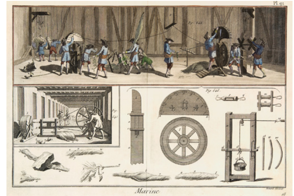
Köydenpunontarata ja sen välineistöä Diderot'n Ensyklopediassa. Köysiä tehtiin kotimaisesta ja venäläisestä hampusta, minkä lisäksi sitä saatiin haaksirikkoaluksista. Silti se oli huutokaupoissa erittäin arvokasta. Lapsityövoima oli tärkeä osa köysituotantoa. Kuva: Mikko Huhtamiehen kokoelmat.
